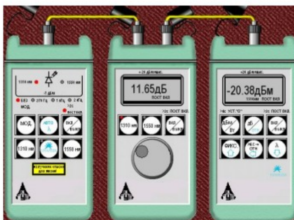
Схема измерения затухания в катушке с волокном методом замещения при помощи аттенюатора
