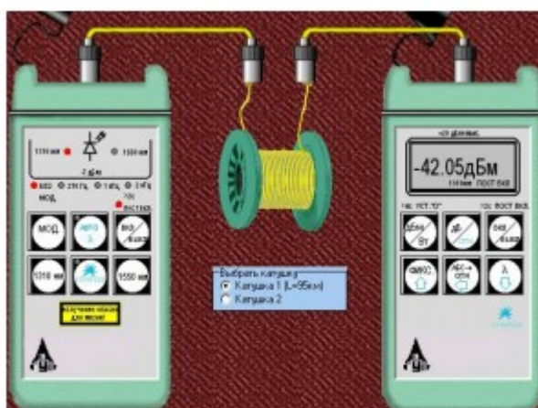
Схема измерения затухания в катушке с волокном методом разности уровней
